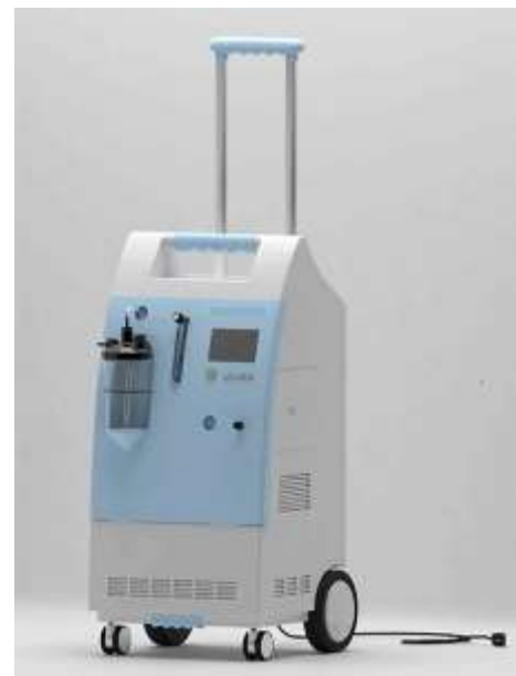
Figura 12. concentrador de oxígeno para oxigenoterapia domiciliaria
