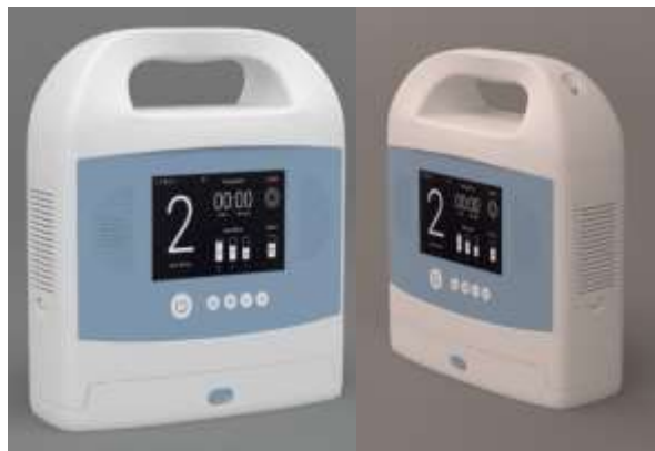
Figura 13. concentrador de oxígeno para oxigenoterapia domiciliaria
