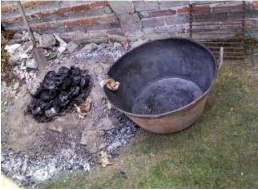
Forma de quema de la Nueva Cerámica de Paquimé: sobre un montículo de tierra se colocan las piezas, el conjunto se tapa con un cazo de acero, se rodea de leña el cazo y enciende hasta consumirse, si se quieren piezas negras por efecto de reducción del  $\text{Fe}_2\text{O}_3$  a  $\text{FeO}$ , se retaca de papeles el conjunto y sella con tierra herméticamente la base.
