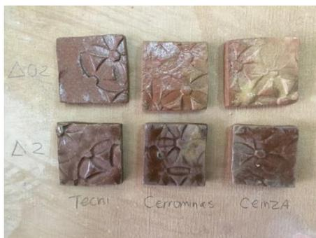
Figura 4: Resultados de pruebas de temperatura de los materiales en estudio. Fuente propia
