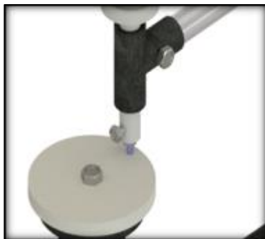
Figura 3. Detalle modelado el dispositivo de desgaste Pin on Disk.
