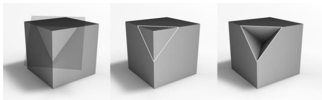
Figura 4a. Elementos de una inflexión. De izquierda a derecha: Plano de inflexión / Límite de la inflexión y región convexa / Límite de la inflexión y región cóncava resultante.
