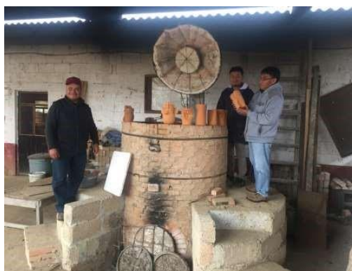
Horno de brocal prototipo In Tekol de Tejuán (El fuego es nuestro en náhuatl) del Centro de Estudios Alfareros (CEA) en San Miguel Tenextatiloyan, Puebla con tapa de fibra cerámica soportada con alambre nicromel en una estructura de varillas soldadas. En la foto de izquierda a derecha: Juan Domingo Martínez Romero, director del CEA, Ramiro Ravelo alfarero destacado cuyas piezas están alrededor del brocal, y sosteniendo una de las piezas el Mtro. Marco Antonio Comunidad Aguilar miembro del cuerpo directivo del Centro de Estudios para el Desarrollo Rural (Cesder), institución de la que es parte el CEA, foto Juan Oliveras.
