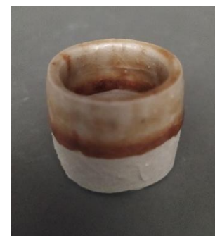
Figura 4 Prueba de engobe vítreo de Saucillo. 50% arcilla de Saucillo, 50% cenizas. Cono 6, quema de oxidación en horno eléctrico.
