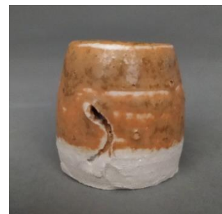
Figura 3 Prueba de engobe vítreo de Saucillo. Cono 6, quema de oxidación en horno eléctrico
